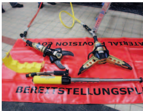
Der neue hydraulische Rettungssatz: Bergeschere, Rettungsspreizer und Hydraulikzylinder
